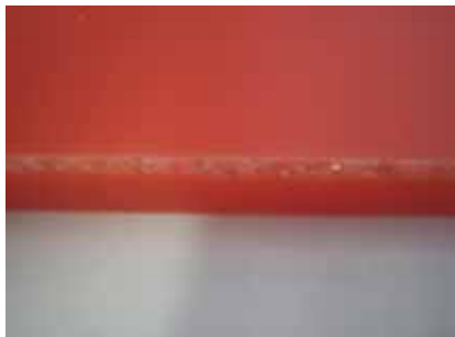
写真 1 摩耗したスキージ
