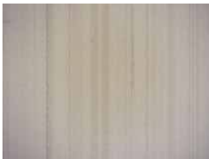
写真 3 摩耗したスキージで印刷
